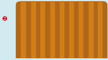
Scherpe zaagranden schuren of licht schaven om voldoende dikte van de verflaag te behouden op de overgang naar de zijkant.
